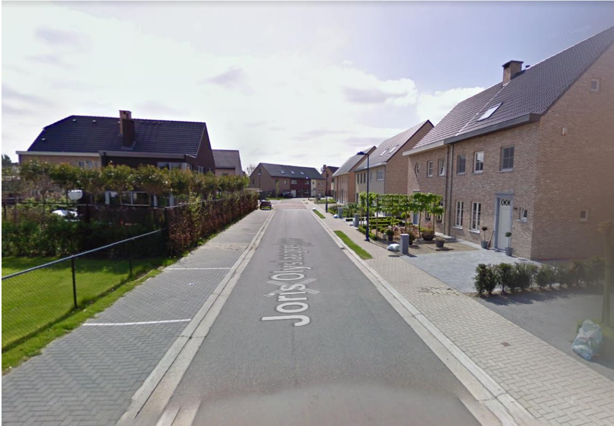
Figuur 27: Reserve parkeerplaatsen in een straat waar elke woning beschikt over een eigen oprit en/of garage. Enerzijds is dit extra verharding, anderzijds moedigt dit het gebruik van het publieke domein om te parkeren aan. Dergelijke parkeerplaatsen worden, indien nodig, beter voorzien als gestabiliseerd groen zodat ze niet bijdragen aan de totale verharding maar indien nodig wel kunnen functioneren.
