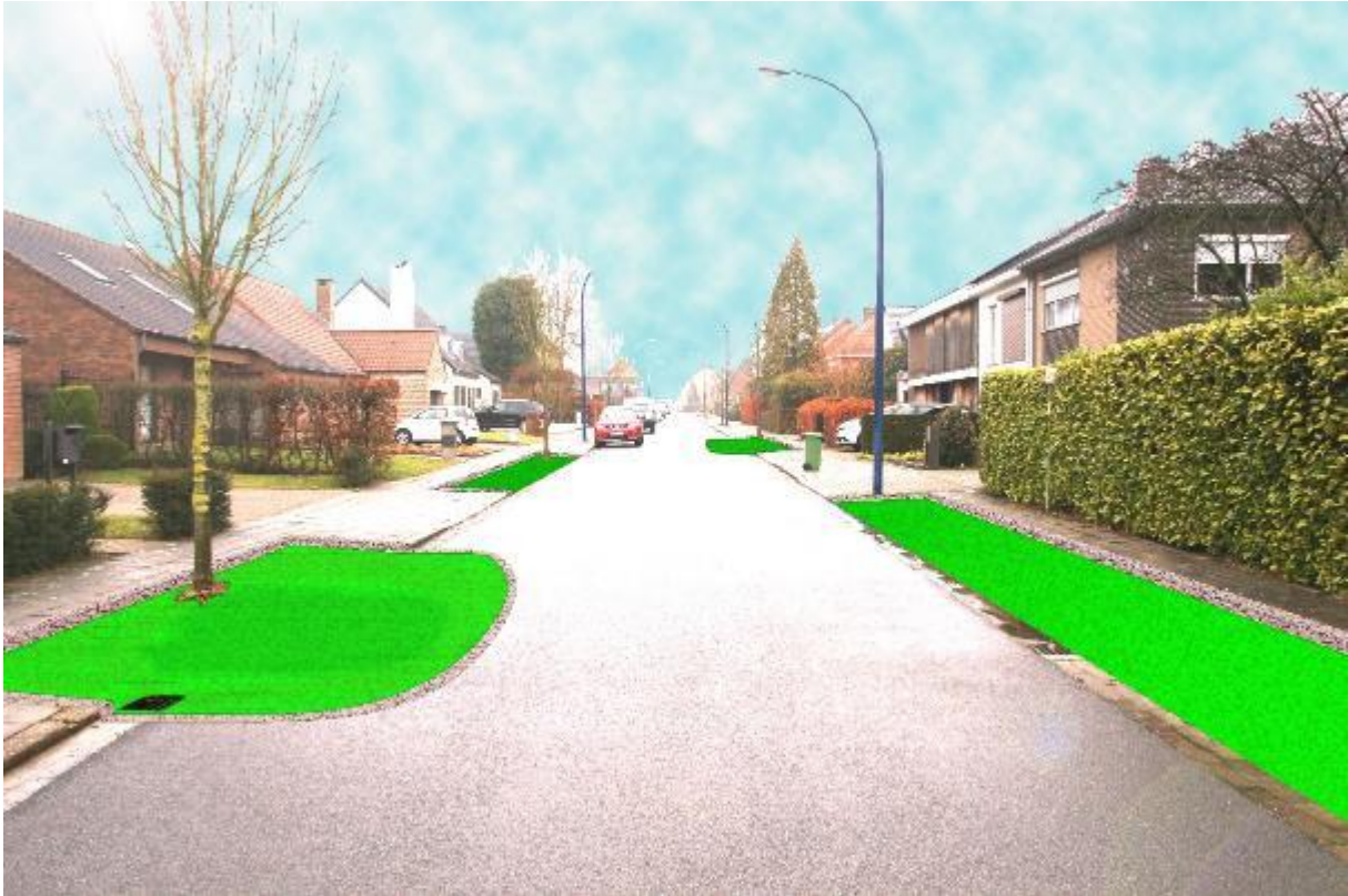
Figuur 21: conceptuele schets van hoe dit onthardingsprincipe er zou kunnen uitzien: ter hoogte van de bomen werd geschrapt een groene zone met depressie tot in de weg doorgetrokken zodat water dat afstroomt in de goten kan infiltreren of toch minstens vertraagd wordt. De bestaande straatkolken blijven functioneren als overloop van de groene bufferzone. In dit voorbeeld werd op de voetpaden ook onthard zodat de bomen niet meer in kleine vakjes staan, maar het groene lint enkel onderbroken wordt aan opritten.
